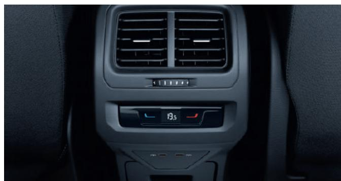
**後座冷氣出風口含觸控式溫控面板**
